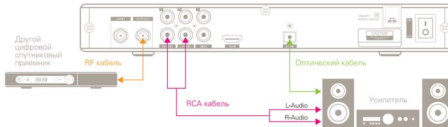
Приемник можно соединить с другим приемником путем подключения RF кабелем разъема LOOP OUT первого к разъему LNB IN второго приемника.
